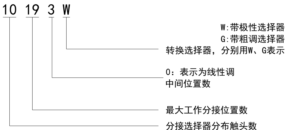
图 3-2 分接选择器基本连接方式说明
